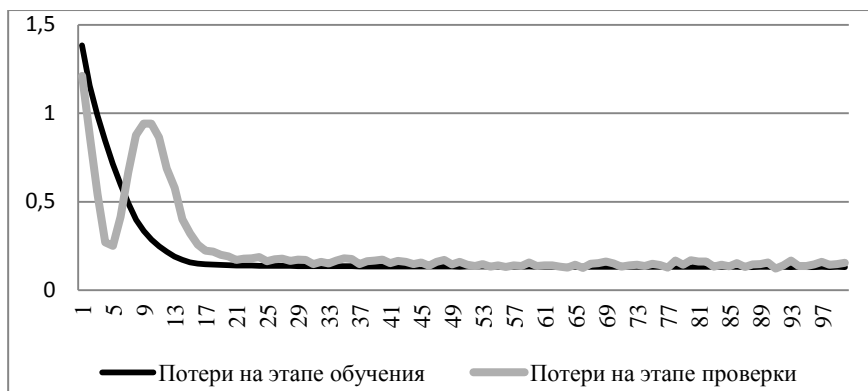
Рисунок 2 – MAE (нормализованное) на валидационной выборке без перекрёстной проверки простейшего нейросетового решения / MAE (normalized) on a validation sample without cross-validation of the simplest neural network solution
